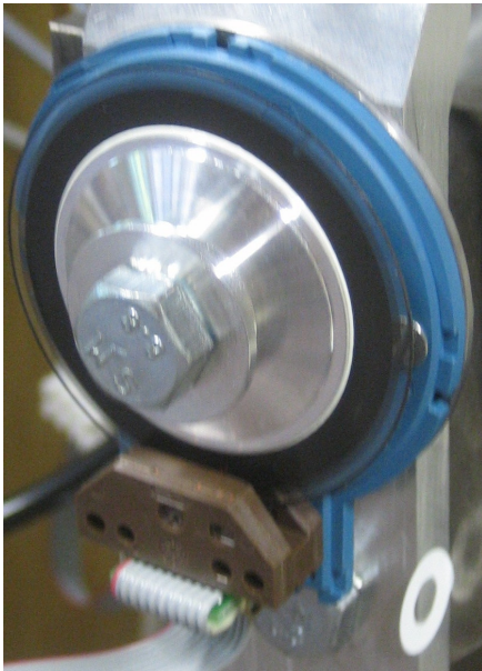
Figuur 2-11: encoderschijf(zwart) en sensor(bruin)
