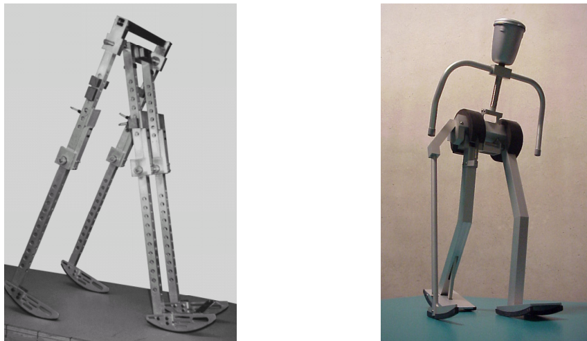
Figuur1-1:Kopie door Ruina et al. van de passieve stapper van McGeer (links) en “Museon” van het Bio Robotics Lab, TU Delft(rechts)
