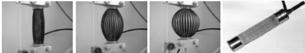
Figuur 17: Nieuw (links, 1 tot 3) en oud (rechts) design van de PPAM ontwikkeld aan de VUB als lichtgewicht actuatoren voor robotica doeleinden.
